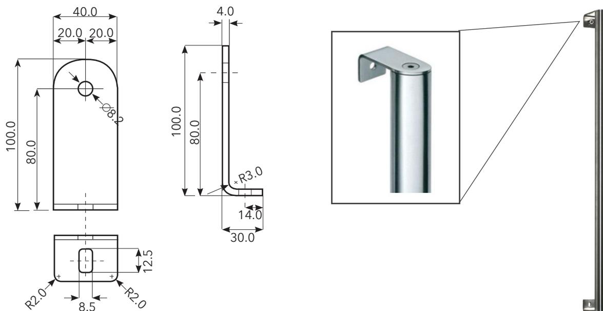
Mögliche Griffdurchmesser sind: 30 mm, 35 mm und 40 mm
