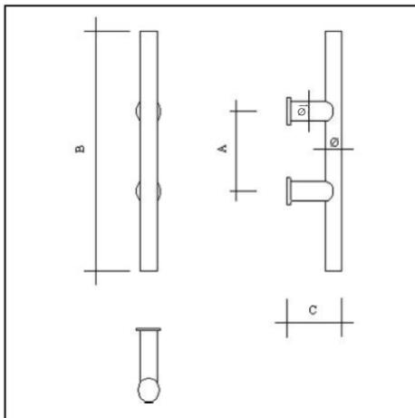
Mögliche Griffdurchmesser: 20 mm, 25 mm, 30 mm, 35 mm und 40 mm
